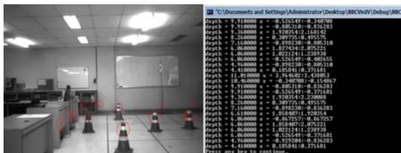
รูปที่ 4 แสดงภาพหลังจากประมวลผล และผลลัพธ์ที่ได้ โดยหาวัตถุที่มีความสูงจากพื้นประมาณ 30-60 เซนติเมตร แล้วหาความลึกและระยะที่ได้ โดยประมวลผลออกมาเป็นตำแหน่งของภาพที่มองได้จากด้านบน
