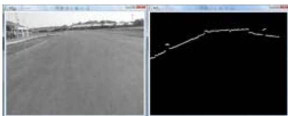
รูปที่ 5 แสดงการตรวจสอบหาเส้นขอบถนน
