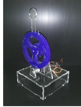
รูปที่ 2 อุปกรณ์แฮปติกส์ 1 องศาอิสระที่ออกแบบโดย BART LAB และภาควิชาวิศวกรรมชีวการแพทย์ คณะวิศวกรรมศาสตร์
