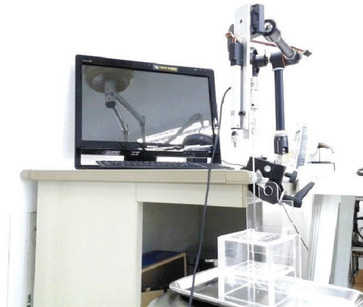
รูปที่ 2 แสดงระบบการติดตั้งเข็มเวเรสต์และเซนเซอร์วัดแรงและแรงบิดเข้ากับแขนหุ่นยนต์
